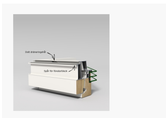
Montering av fönsterbleck LKF1283 Royal. Dräneringshålen sitter undertill. Fönsterblecket monteras i det inre spåret, innanför dräneringshålet.
